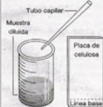
Se disuelve la muestra para dejarla en estado líquido y se prepara un tubo capilar. Se prepara al mismo tiempo una placa de celulosa absorbente y se dibuja una línea de base a un par de centímetros del borde inferior.
