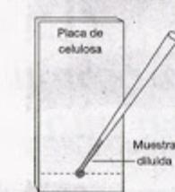
Con el tubo capilar, y usando la línea de base, se aplica una gota de la muestra en la placa de celulosa, procurando que se extienda lo menos posible y que no dañe la capa. A continuación, se deja secar.
