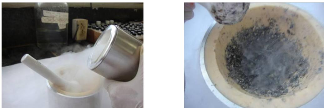
**Fig. 20.** Pulverización de los líquenes empleando nitrógeno líquido.
