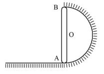
48.- La barra AB de longitud L y peso P está articulada a tierra en O y forma 30° con la vertical. El extremo A se une a la cuerda fija a tierra. Si se corta esta cuerda y la barra inicia su movimiento por efecto de la gravedad; determinar la magnitud de la reacción que genera la articulación sobre la barra para el instante en que ella vuelve de nuevo a formar 30° con la vertical.
