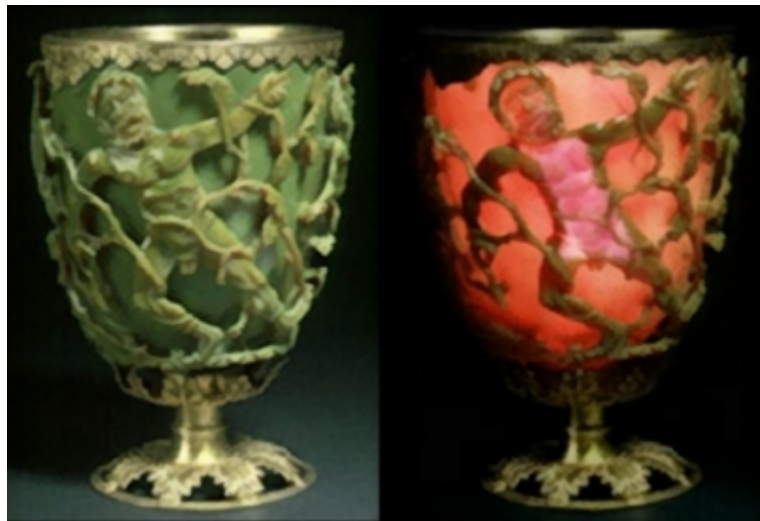
Figura 1: Copa de Licurgo (Roma, siglo IV D.C). Copa hecha con un vidrio dicróico que contiene oro coloidal, lo que hace que cambie de color verde a rojo cuando se hace pasar luz a través de ella. Este fenómeno es debido a la SPR de los coloides de oro.
