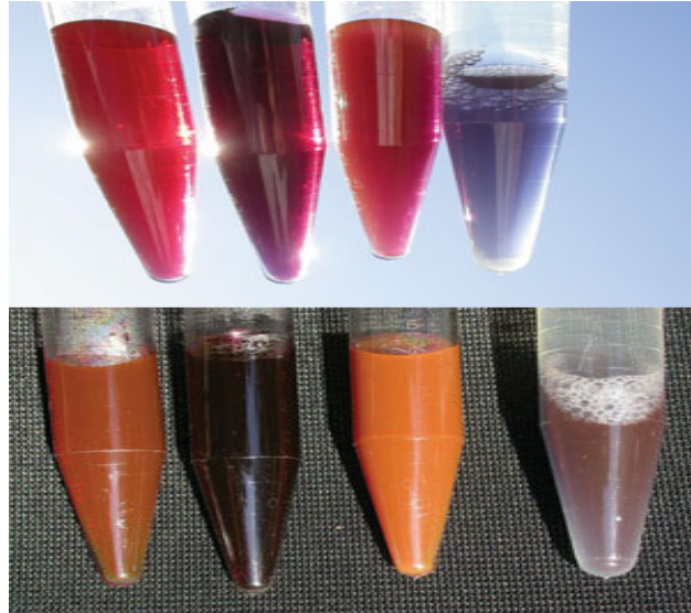
Figura 5: (Arriba) Gama de colores observada para soluciones de diferentes tamaños de nanopartículas de oro en luz transmitida. (Abajo) Las mismas soluciones pero ahora observadas con luz reflejada.
