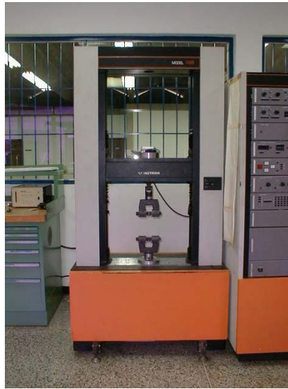
Figura N° 7. Equipo de ensayos universales (Laboratorio E Sección polímeros USB).
