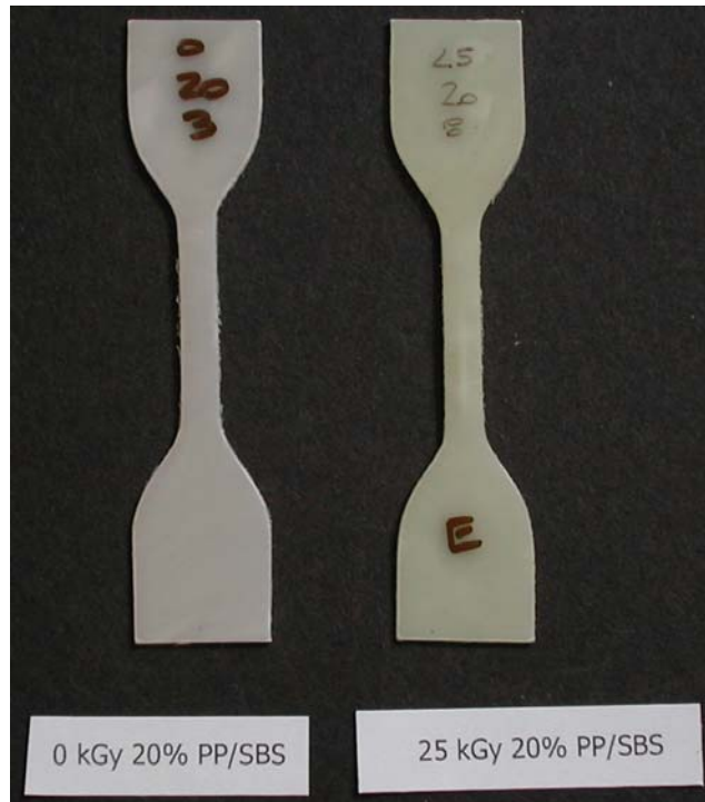
Figura N° A3. Diferencias de color para probetas de una mezcla con 20% de SBS sometida a 25 kGy.
