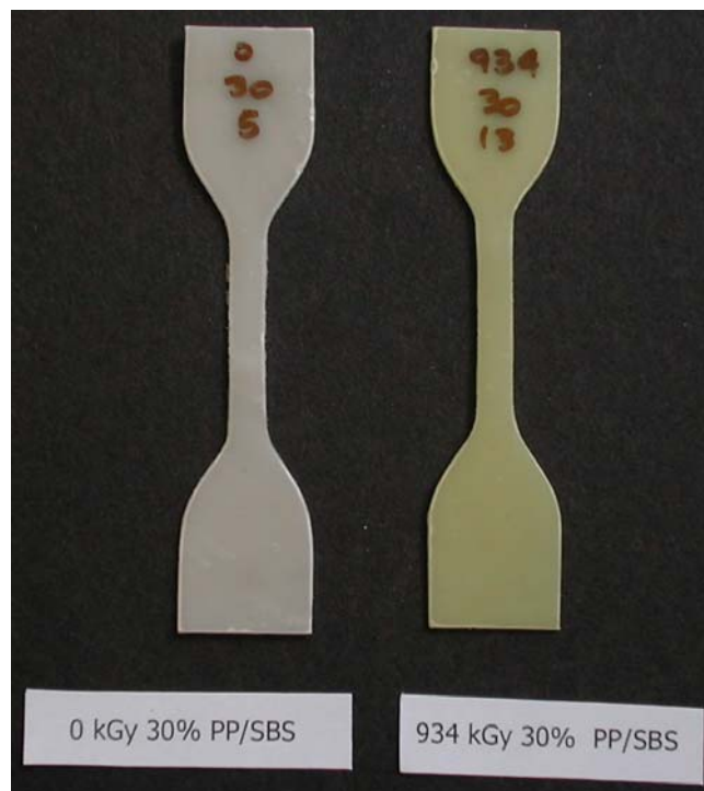
Figura N° A19. Diferencias de color para probetas de una mezcla con 30% de SBS sometida a 934 kGy.
