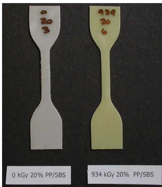
Figura N° A18. Diferencias de color para probetas de una mezcla con 20% de SBS sometida a 934 kGy.
