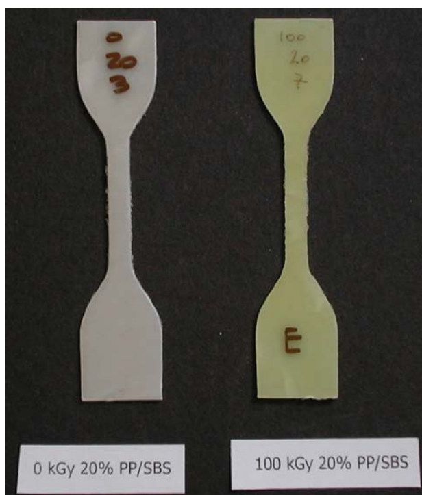
Figura N° A8. Diferencias de color para probetas de una mezcla con 20% de SBS sometida a 100 kGy.
