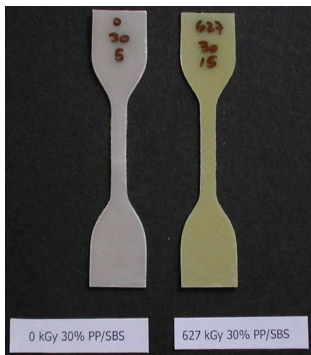
Figura N° A14. Diferencias de color para probetas de una mezcla con 30% de SBS sometida a 627 kGy.
