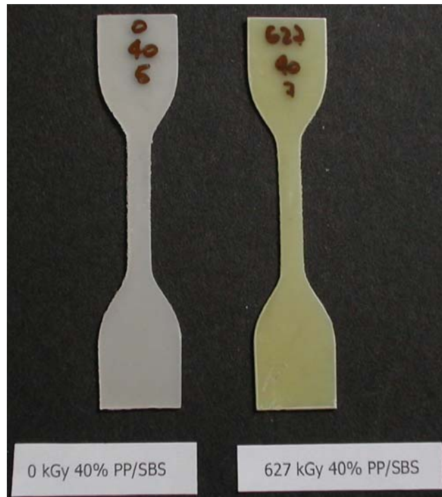
Figura N° A15. Diferencias de color para probetas de una mezcla con 40% de SBS sometida a 627 kGy.
