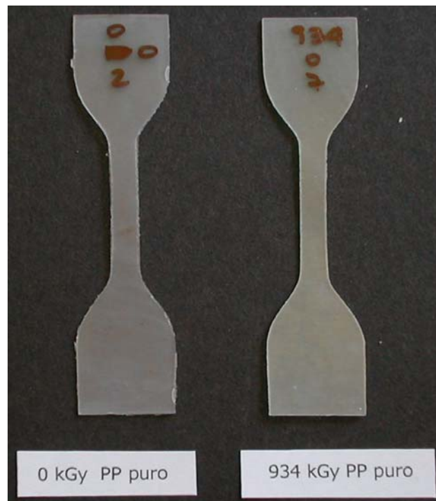
Figura N° A16. Diferencias de color para probetas de PP puro sometida a 934 kGy.
