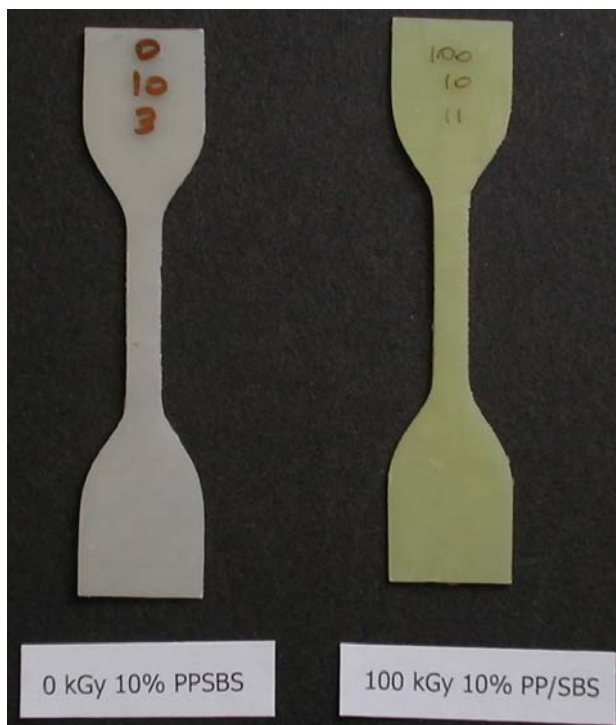
Figura N° A7. Diferencias de color para probetas de una mezcla con 10% de SBS sometida a 100 kGy.
