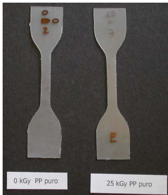
Figura N° A1. Diferencias de color para probetas de PP puro sometida a 25 kGy.
