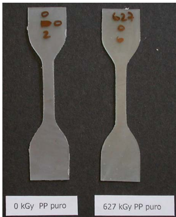
Figura N° A11. Diferencias de color para probetas de PP puro sometida a 627 kGy.
