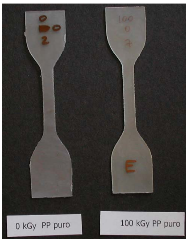
Figura N° A6. Diferencias de color para probetas de PP puro sometida a 100 kGy.
