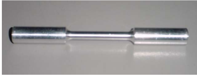
Figura 20. Probeta fabricada para ensayos de tracción.
