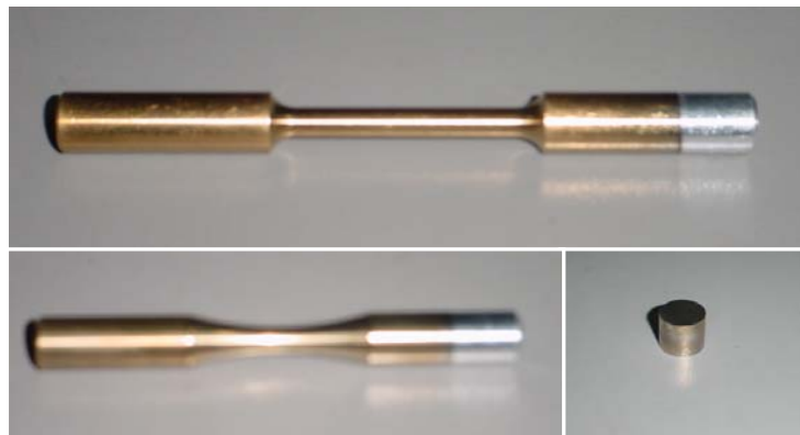
Figura 27. Probetas recubiertas con TiN.
