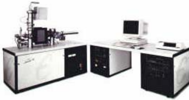
Figura 30. Equipo de SNMS Leybold INA 3.
