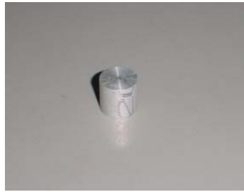
Figura 26. Probeta cilíndrica para evaluación del recubrimiento de TiN.
