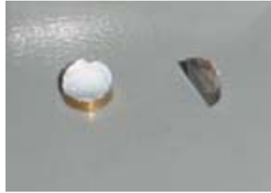
Figura 44. Muestras cortadas para evaluación fractográfica mediante SEM.
