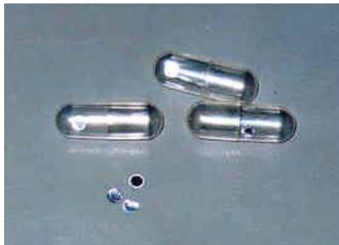
Figura 53. Muestras preparadas para evaluación por TEM ( foils ).
