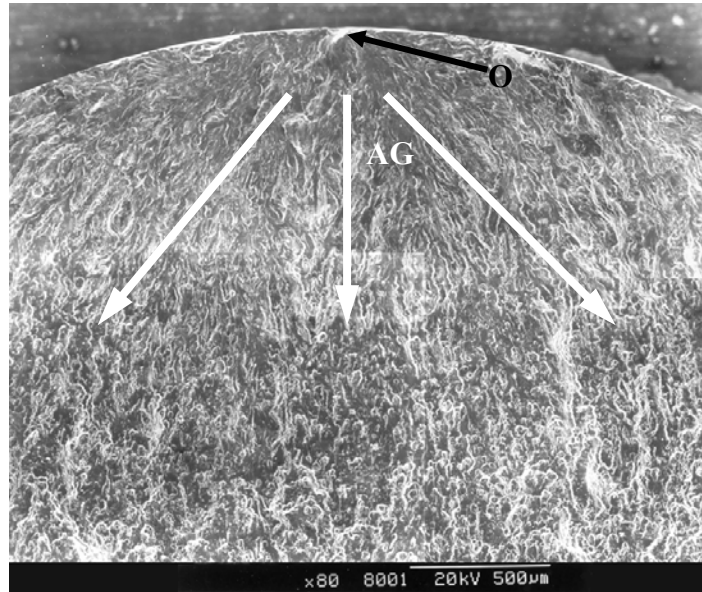
Figura 84. Inicio de grieta en superficie de fractura de la probeta N° 1 ( S = 219 \text{ MPa} , N_f = 244400 ciclos).
