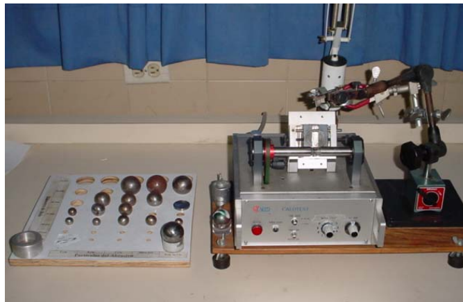
Figura 31. Equipo CSEM CALOTEST.
