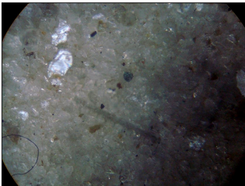
Figura 6. Imagen de la muestra de los residuos obtenidos posterior a la digestión de los carbonatos, vista en un microscopio óptico, con un aumento de 4x.
