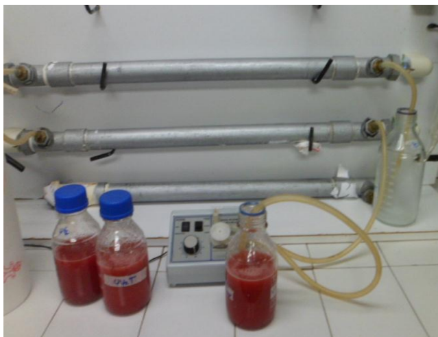
Figura 18. Aplicación de luz ultravioleta al jugo de patilla natural.
