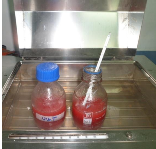
Figura 17. Aplicación del tratamiento térmico suave al jugo de patilla en baño de María.
