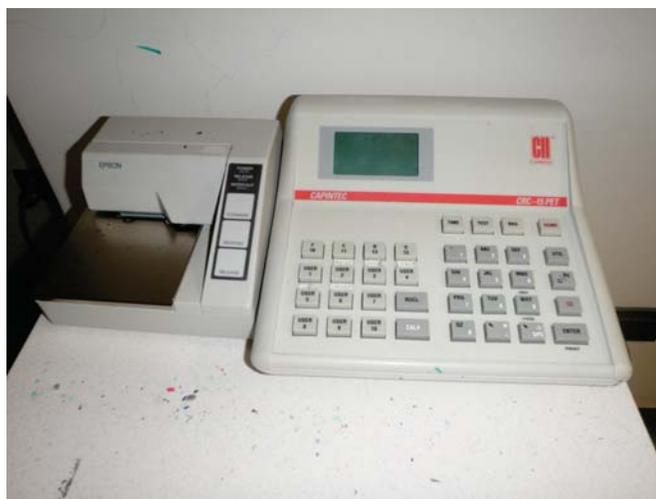
Figura A.26: Activímetro ubicado en el CDD
