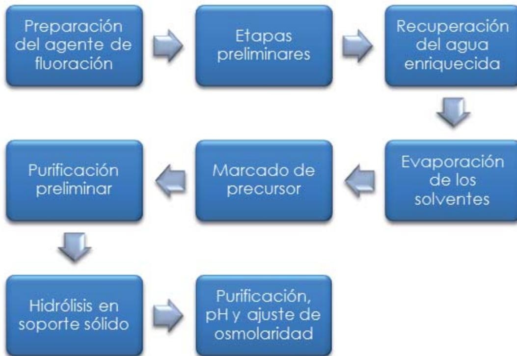
**Figura 3.10:** Esquema del Proceso Químico a través del cual se sintetiza el FDG.
