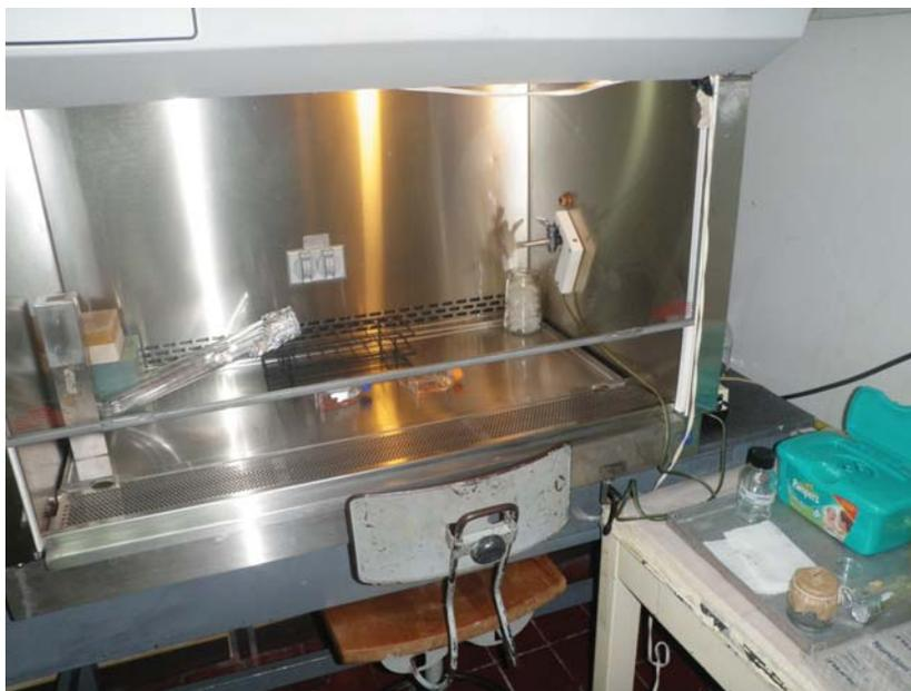
**Figura A.14:** Área de Trabajo: campana de flujo laminar, a la derecha bandeja de descarte y algunos materiales antes de ser ingresados a la campana. IBE.
