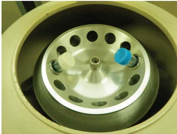
**Figura 5.5:** Forma correcta de ubicar tubos dentro de la centrífuga, IBE.
