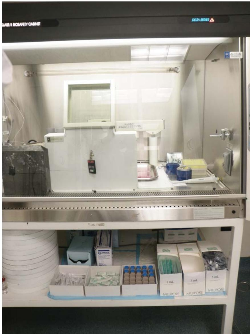
**Figura A.15:** *Campana de Flujo laminar instalada en el CDD, dentro de la cabina está una L plomada, termómetro digital, brazo mecánico, recipiente para desechos; y debajo están los viales, inyectadoras y demás implementos estériles necesarios para la dosificación.*
