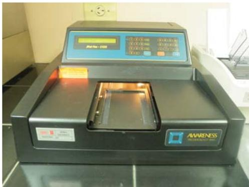
(a) Espectrofotómetro del Laboratorio de Productos Naturales, UCV
