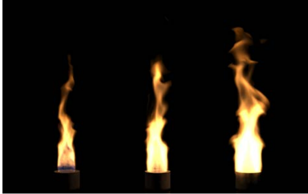
Figura 3: Comparación de las formas de una llama para diferentes grados de expansión de gases. De izquierda a derecha se puede apreciar como el fluido se hace más turbulento en la simulación [6].
