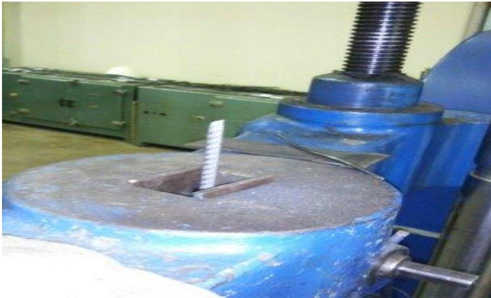
**FOTOS # 5 y # 6: Ensayos de tracción.**
