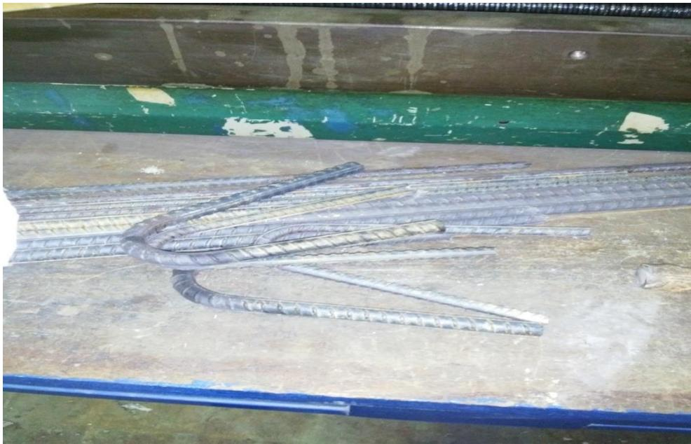
**FOTO # 10: Muestras del ensayo de doblado.**
