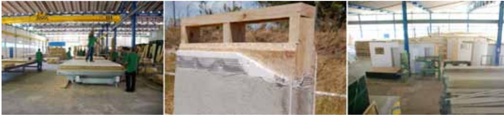
Colocación de acabados y anclajes
