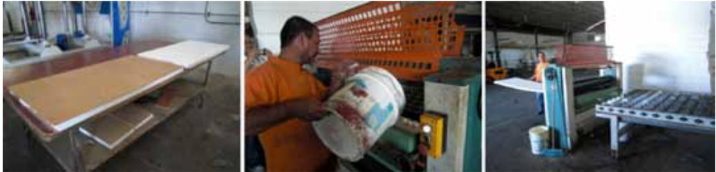
Colocación del encolado en tableros y láminas de eps
