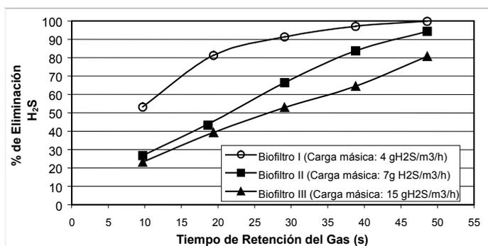
**Figura 1.** Eliminación de H<sub>2</sub>S en función del tiempo de retención para diferentes cargas máscicas en los biofiltros.
